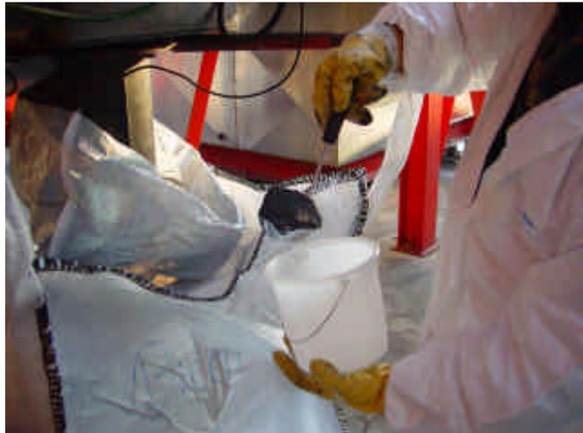
**Abbildung 6:** Probenahme Trockensorptionsrückstand
